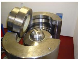
Рис. 1. Многопуансонный аппарат высокого давления “БАРС”.
