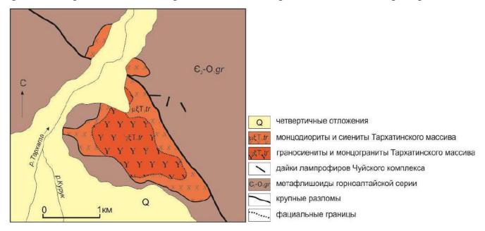
Рис. 4. Геологическая схема Тархатинского массива [Крупчатников, 2010].
