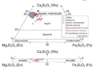
Рис. 35. Составы пироксенов из пород пермо-триасовых интрузивных серий Алтая, вынесенные на классификационную диаграмму миналов (MgSiO<sub>3</sub>-FeSiO<sub>3</sub>-CaSiO<sub>3</sub>) [Morimoto et al., 1988].
