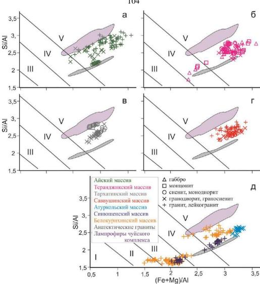
Рис. 39. Составы биотитов из пород пермо-триасовых интрузивных серий Алтая на диаграмме [Маракушев, Тарарин, 1965]. Поля составов слюд из гранитов различной щелочности: I, II — низкощелочные с высокоглиноземистыми минералами, III — нормальной щелочности, IV — повышенной щелочности, V — щелочные граниты, чарнокиты, сиениты. Анатектические граниты — Боровлянский массив. а-г — габбро—гранитные серии, д — существенно граносиенитовые и гранит-лейкогранитовые ассоциации.
