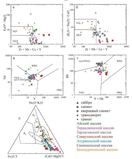
Рис. 32. а, б - Классификационные диаграммы «Zr+Nb+Ce+Y - FeO\*/MgO» и «Zr+Nb+Ce+Y - Na<sub>2</sub>O+K<sub>2</sub>O/CaO» [Whalen et al., 1987]. Поля: FG - фракционированные граниты A-граниты A-гипа, OGT - нефракционированные граниты M, S и I-типов;
