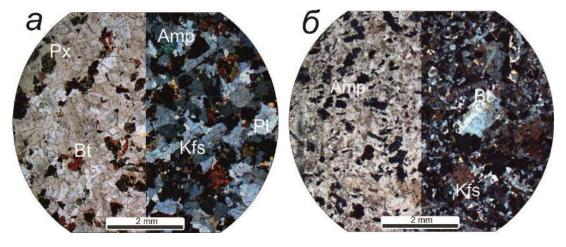
Рис. 12. Породы Тархатинского массива. На каждом фото слева николи параллельны, справа – скрещены. а – монцодиорит, б – сиенит.
