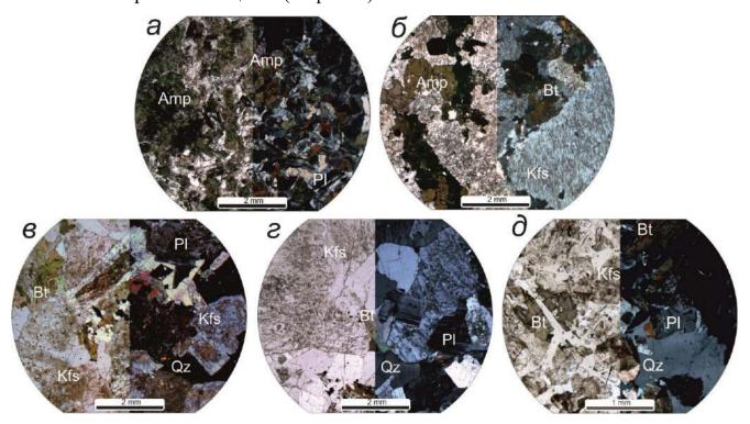
Рис. 10. Породы Айского массива. На каждом фото слева николи параллельны, справа – скрещены. а – габбро, б – сиенит, в – граносиенит, г – гранит, д – лейкогранит.
