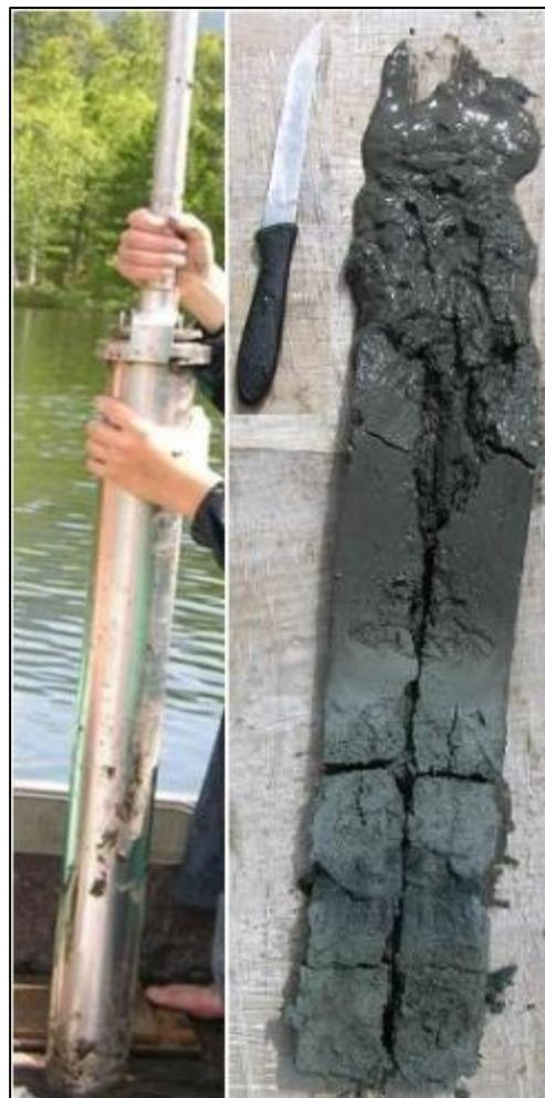
**Рисунок 3.1.** Цилиндрический пробоотборник с вакуумным затвором конструкции НПО «Тайфун» и керн донных отложений
