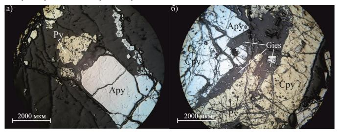
Рис. 2.3. Золото-пирит-арсенопиритовая минеральная ассоциация (николи параллельны): а – катаклазированные кристаллы арсенопирита (Ару) и пирита (Ру) в кварцевой жиле; б – характерные взаимоотношения арсенопирита и пирита с халькопиритом (Сру) и гиссенитом (Gies).
