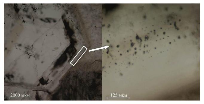
Рис. 5.1. Флюидные включения, расположенные по зонам роста кристалла кварца.
