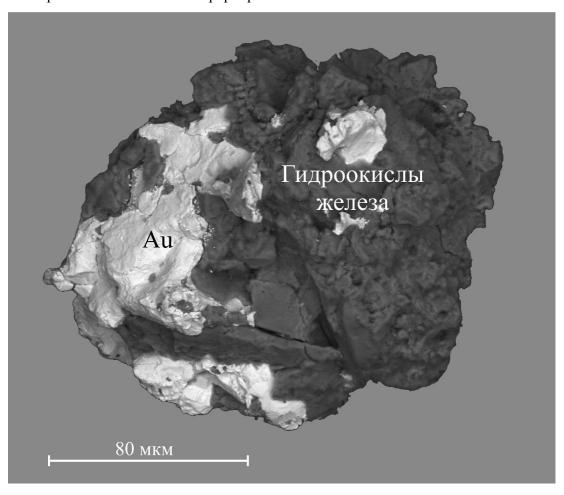
Рис. 2.18. Высокопробное золото в лимонитовой "рубашке" (снято в отраженных электронах).
