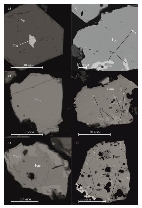
Рис. 4.5. Золото-полиметаллическая минеральная ассоциация (снято в отраженных электронах): а – включения галенита в пирите; б – включение теннантита в пирите; в – теннантит в основной массе породы; г – замещение тетраэдрита фаматинитом; д – замещение фаматинита халькостибитом; е – штромейерит, развитый на краю зерна фаматинита.
