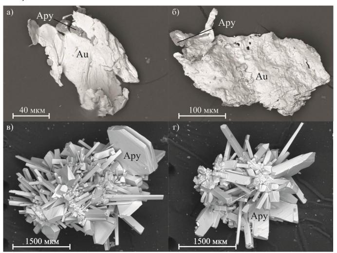
Рис. 4.7. Золото-пирит-арсенопиритовая минеральная ассоциация Савкинского месторождения (снято в отраженных электронах): а, б – самородное золото (Au) в срастаниях с арсенопиритом; в, г – игольчатые кристаллы арсенопирита (Apy).
