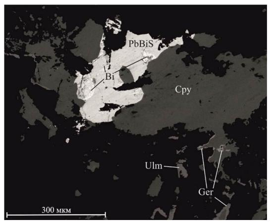
Рис. 3.8. Характерное взаимоотношение висмутовых минералов с халькопиритом (снято в отраженных электронах)
