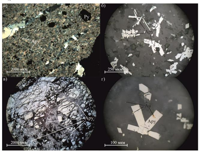
Рис. 3.4. Золото-пирит-арсенопиритовая минеральная ассоциация (николи параллельны): а – кварц-серицитовый метасоматит с вкрапленностью пирита (Ру) и арсенопирита (Ару); б – удлиненно-призматические и игольчатые кристаллы арсенопирита; в – катаклазированные кристаллы пирита, сцементированные тонко-призматическими кристаллами арсенопирита; г – самородное золото (Au) в срастании с арсенопиритом.
