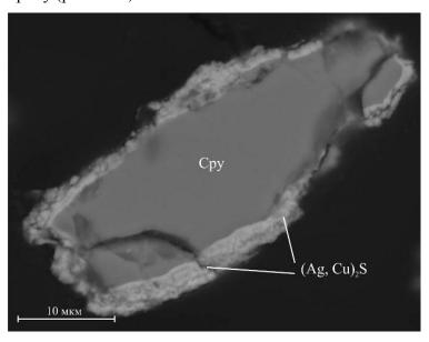
Рис. 2.17. Маккинстриит ((Ag,  $Cu)_2S$ ), развитый по халькопириту (Сру) (снято в отраженных электронах).
