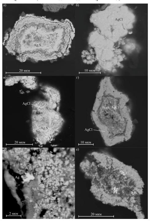
Рис. 2.16. Гипергенная Аи и Ад минерализация (снято в отраженных электронах).
