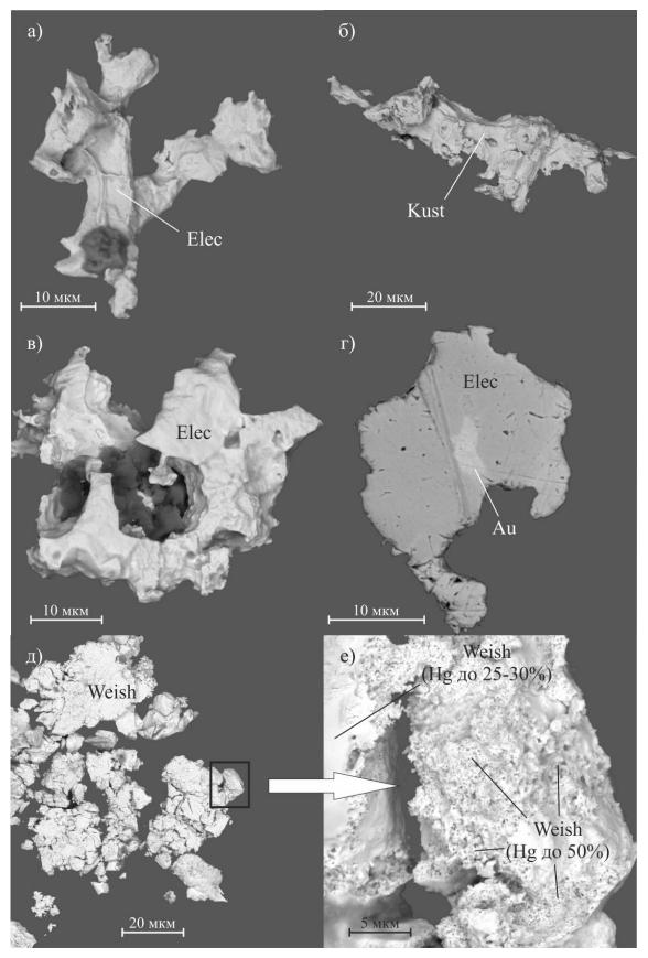
Рис. 2.12. Золото-серебряная минеральная ассоциация (снято в отраженных электронах).
