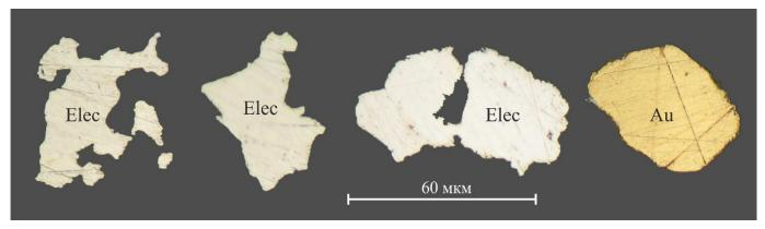
Рис. 2.14. Формы выделения электрума (Elec) и высокопробного самородного золота (Au).
