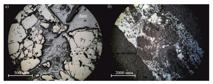
Рис. 3.10. Характерные взаимоотношения минералов сульфосольной ассоциации с ранними золоторудными ассоциациями (николи параллельны): а – идиоморфные кристаллы пирита (Ру), сцементированные джемсонитом (Jem); б – менегинит (Men) цементирует арсенопирит (Ару), пирит и сфалерит (Sf).
