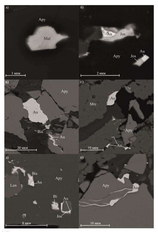
Рис. 3.9. Характерные взаимоотношения минералов золото-висмут-теллуридной ассоциации (снято в отраженных электронах).
