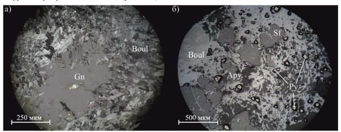
Рис. 3.7. Характерное взаимоотношение Au-Pb-Zn минеральной ассоциации с Au-Py-Apy и сульфосольной: а — замещение галенита (Gn) буланжеритом (Boul) (николи скрещены); б — буланжерит цементирует ранний пирит (Ру), арсенопирит (Ару) и сфалерит (Sf) (николи параллельны).
