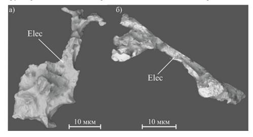
Рис. 2.13. Морфология самородного золота Au-Ag минеральной ассоциации (снято в отраженных электронах): а – трещинные прожилковые выделения электрума (Elec); б – проволоковидный индивид электрума.
