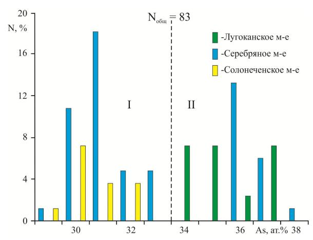
Рис. 7.2. Состав арсенопиритов Лугоканского рудного узла.
