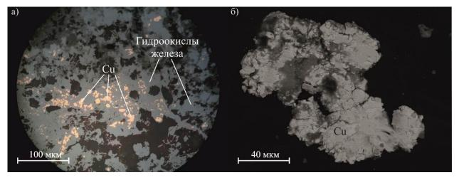
Рис. 2.15. Самородная медь (Cu) в агрегате гидроокислов железа (а – николи параллельны), с примесью Sn до 15% (б – снято в отраженных электронах).
