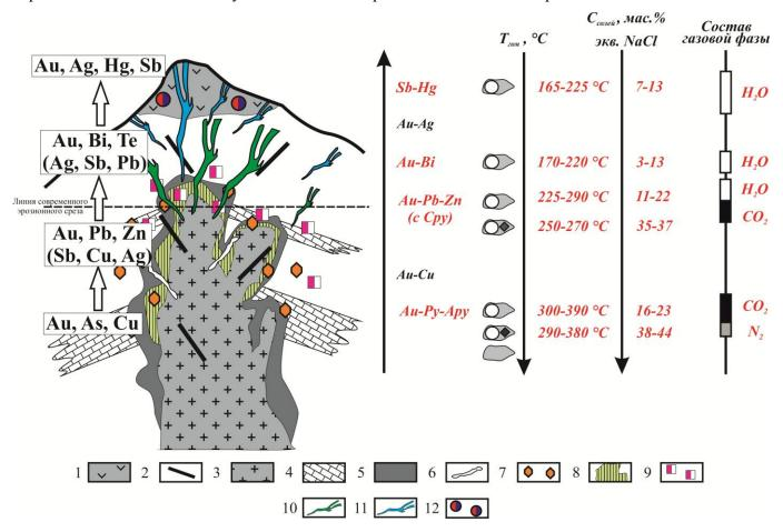
Рис. 7.1. Идеализированная схема вертикальной зональности Лугоканского месторождения.
