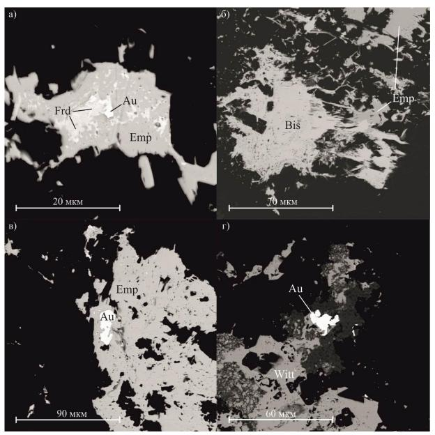
Рис. 2.8. Характерное взаимоотношение висмутовых и висмутсодержащих минералов в первом парагенезисе (снято в отраженных электронах).
