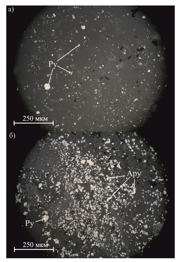
Рис. 4.3. Золото-пирит-арсенопиритовая минеральная ассоциация Солонеченского месторождения (николи параллельны): а — вкрапленность пирита (Ру) в известняке; б — вкрапленность арсенопирита (Ару) и пирита в брекчированном алевролите.
