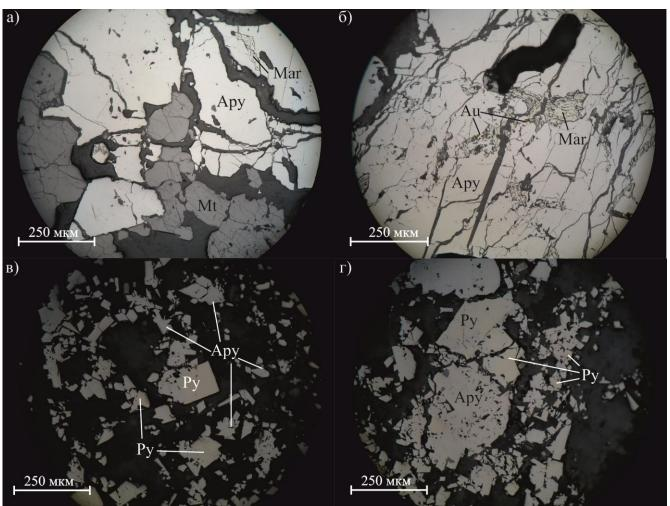
Рис. 3.5. Мышьяковистый арсенопирит (николи параллельны): а — катаклазированные кристаллы арсенопирита в известковых скарнах; б — самородное золото (III) в микротрещинах арсенопирита; в,г — замещение пирита арсенопиритом в эндоконтактовой части дайки монцонит-порфиров.
