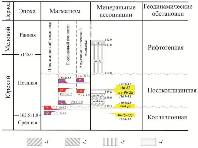
Рис. 6.5. Возраст золоторудной минерализации и ее корреляция с магматическими комплексами юрского возраста. Цифрами показаны рубежи формирования золотого и золотосодержащего оруденения: 1 — Си-Мо (Au), Шахтаминское месторождение; 2 — Au-Pb-Zn, Дарасунское месторождение и Карийский рудный узел (Амурская дайка); 3 — Au-Ag, Балейское и Карийский рудный узел (Пильнейское месторождение); 4 — Sb-Hg (Au), Жипкошинское месторождение.
