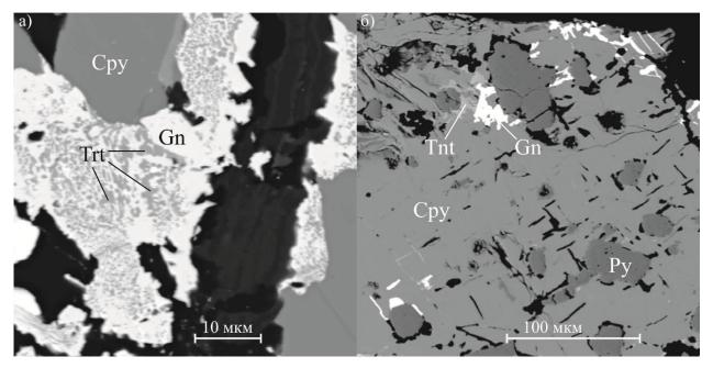
Рис. 2.7. Характерное взаимоотношение минералов золото-полиметаллической минеральной ассоциации (снято в отраженных электронах): а – мирмекитовые включения тетраэдрита (Trt) в галените (Gn); б – галенит и теннантит (Tnt) развиты по микротрещинам в халькопирите (Сру) в ассоциации ранним пиритом (Ру).
