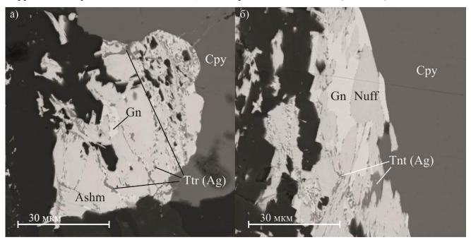
Рис. 2.9. Характерное взаимоотношение висмутовых и висмутсодержащих минералов во втором парагенезисе (снято в отраженных электронах).
