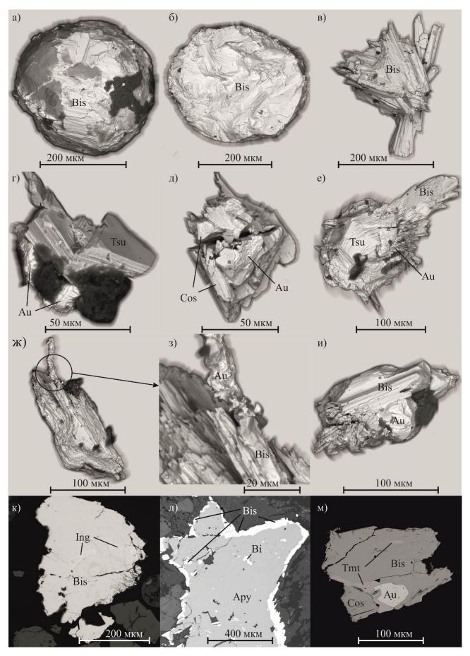
Рис. 2.10. Характерное взаимоотношение висмутовых и висмутсодержащих минералов в третьем парагенезисе (снято в отраженных электронах).
