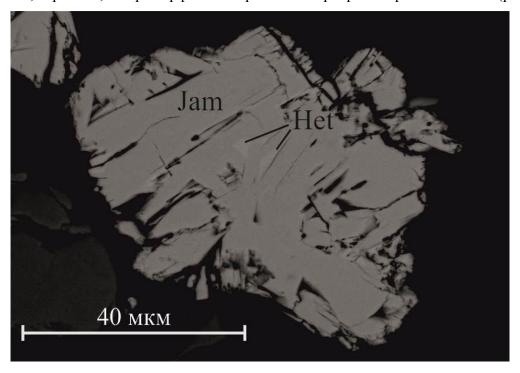
Рис. 3.11. Включения гетероморфита (Het) в джемсоните (Jam) (снято в отраженных электронах).
