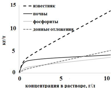
Рис. 3. Зависимость сорбционной способности материалов от концентрации металлов в растворе
