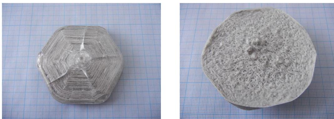
Рис. 4.18. Фотография кристалла  $\beta$ -BaB<sub>2</sub>O<sub>4</sub>, выращенного в системе 0.6 BaB<sub>2</sub>O<sub>4</sub> – 0.4 LiBaBO<sub>3</sub>.
