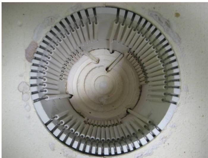
Рис. 2.5. Двухзонный нагреватель ростовой печи для выращивания кристаллов  $\beta\text{-BaV}_2\text{O}_4$ .
