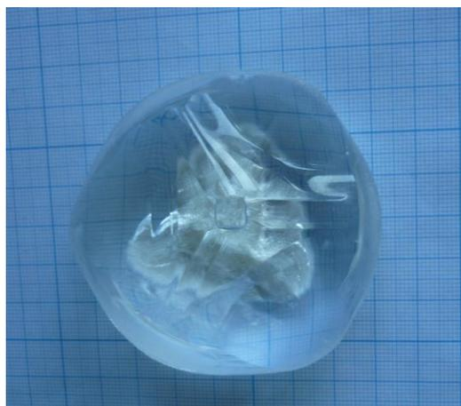
Рис. 4.12. Фотография кристалла  $\beta$ - $\text{BaB}_2\text{O}_4$ , выращенного в системе  $\text{BaB}_2\text{O}_4 - \text{LiF}$  в первом ростовом цикле.
