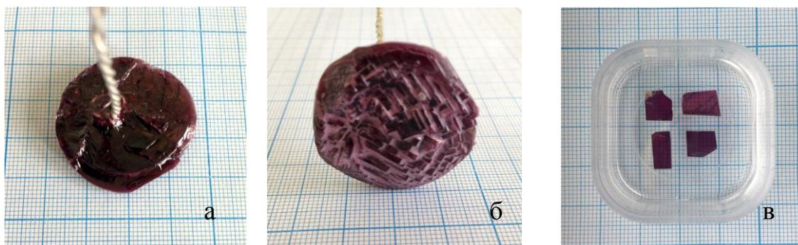
Рис. 3.6. Кристалл  $Ba_3(BO_3)_{2-x}F_{3x}$ , выращенный на платиновую петлю (а, б), изготовленные из него пластинки (в).
