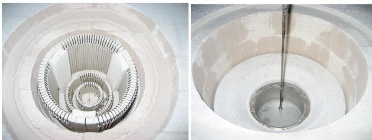
Рис. 2.3. Конструкция нагревателя и компоновка тигля в установке № 43 для выращивания кристаллов  $\beta\text{-BaV}_2\text{O}_4$  из тигля диаметром 145 мм.
