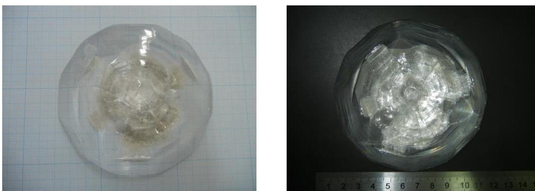
Рис. 4.15. Фотографии кристалла  $\beta$ -BaV<sub>2</sub>O<sub>4</sub>, выращенного в системе BaV<sub>2</sub>O<sub>4</sub> – LiBaF<sub>3</sub> во втором ростовом цикле.
