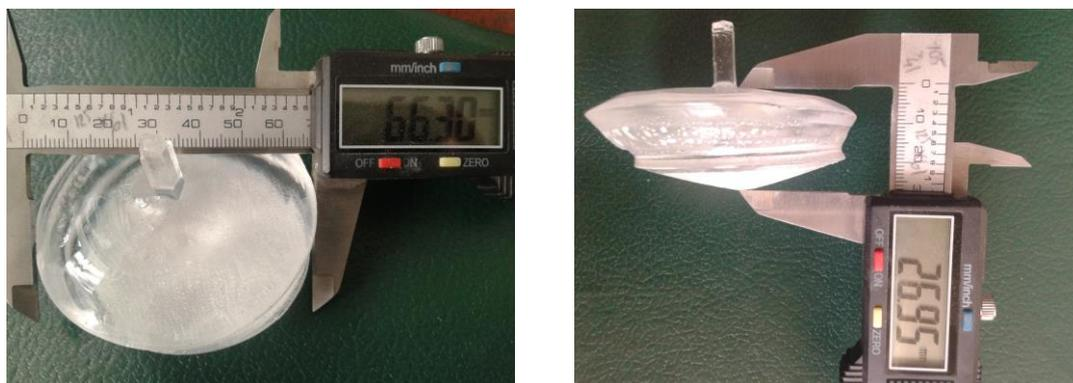
Рис. 4.19. Фотография кристалла  $\beta$ - $\text{BaV}_2\text{O}_4$ , выращенного в системе  $0.7 \text{ BaV}_2\text{O}_4 - 0.3 (0.4 \text{ NaF} - 0.6 \text{ LiF})$ .
