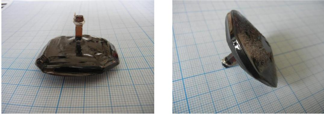
Рис. 5.7. Фотография кристалла  $\text{LiBa}_{12}(\text{BO}_3)_7\text{F}_4$  (49.25 г.), обладающего эффектом дихроизма.
