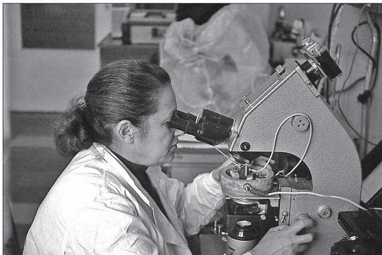
Т.Ю. Базарова. Первая высокотемпературная термокамера для гомогенизации расплавных включений в минералах из магматических пород. 1969 г.
