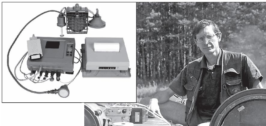
И.Н. Злыгостев на машине разведки при испытаниях инженерного гидролокатора ИГ-1МС (слева)
